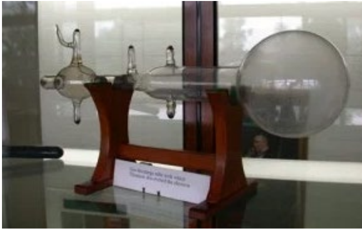
Fig. 1.8. Tubo al vacío que utilizó J. J. Thomson, con el cual descubrió el electrón, la primera partícula subatómica en ser descubierta. Museo del Laboratorio de Cavendish.
