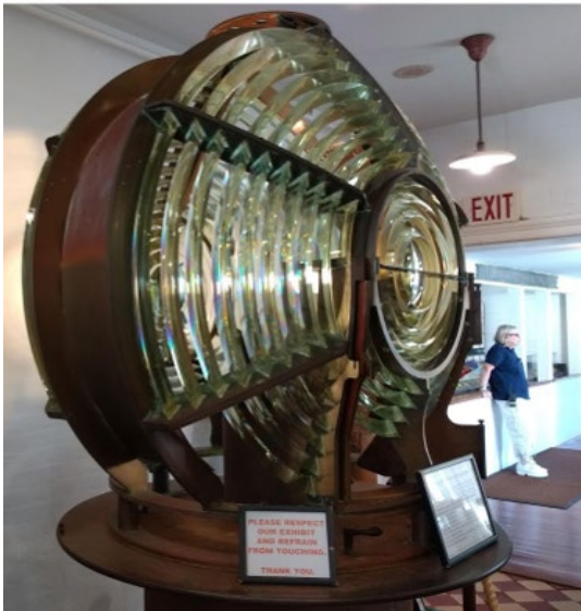
Fig. 5.45. Lente de Fresnel del faro de Montauk Point, sobre la playa, donde se unen el mar y el sonido, en Long Island. Fuente propia.
