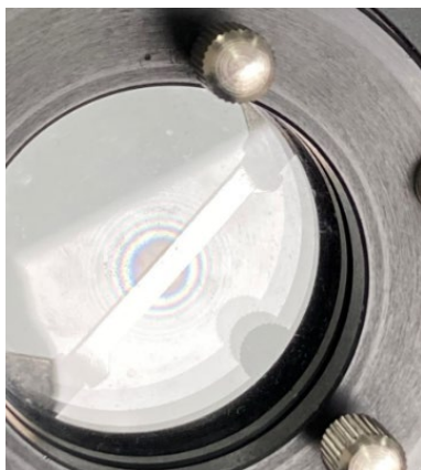
Fig. 7. 16. Fotografía de anillos de Newton en el Laboratorio de Óptica - Universidad de Nariño, primer semestre 2025. Fuente propia.
