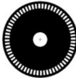
Figura 41. Construcción encoder incremental.
