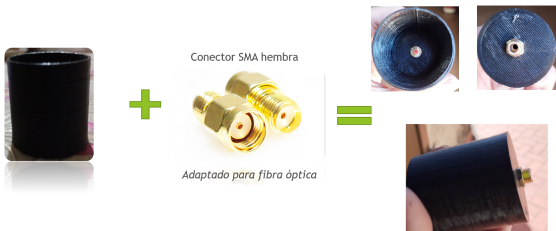
Figura 3.3: Acople ocular creado para el trabajo experimental
