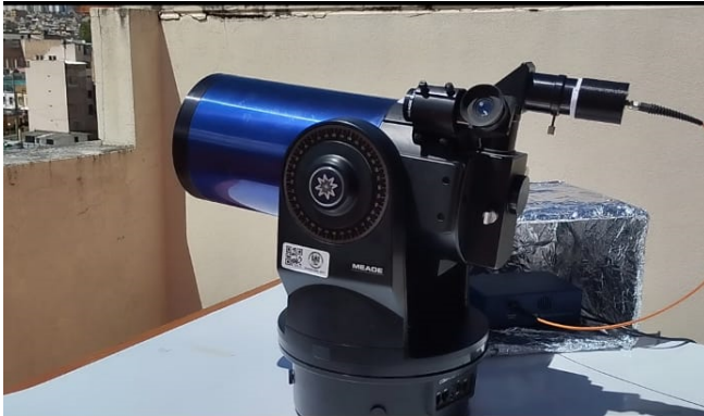
Figura 3.4: Montaje del equipo de Sensado Remoto, donde se observa el telescopio, caja de cartón envuelta de papel aluminio (con el espectrómetro adentro)
