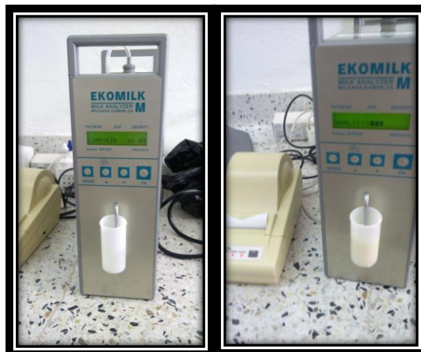
Figura 3. Análisis ultrasónico Ekomilk.
