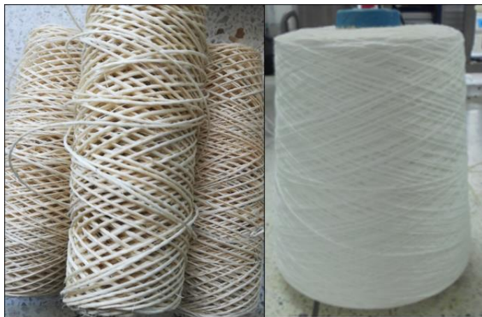
Imagen 4.5. Fibras vegetales; fibra de fique ( Furcraea spp ) y fibra de algodón ( Gossypium hirsutum ).
