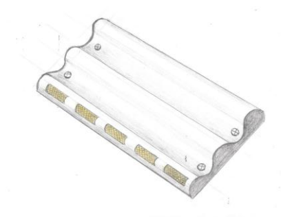
Figura 38. Boceto reductores de velocidad
