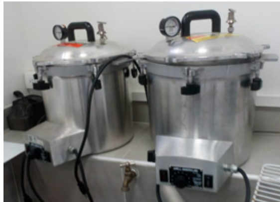
Figura 27. Autoclave vertical, permite la destrucción de microorganismos.
