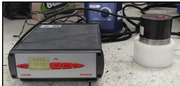
Imagen 3.2. Equipo HygroLab C1 ROTRONIC
