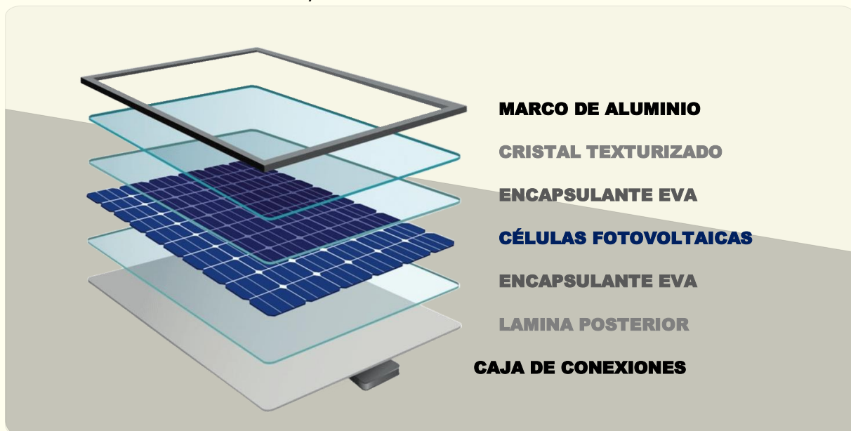
Ilustración 61. Estructura de un panel solar.
