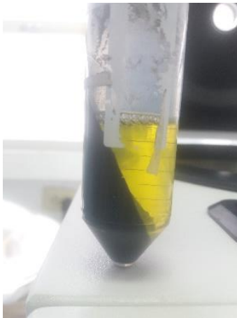
Figura 15. Muestra después de la extracción QuEChERS Fuente: esta investigación.
