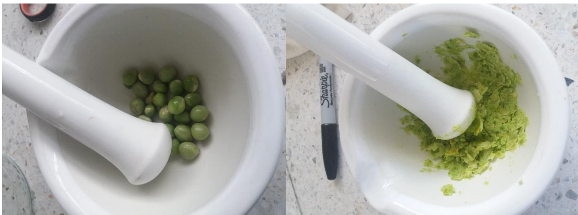
Figura 11. Trituración y homogenización de muestra Fuente: esta investigación.
