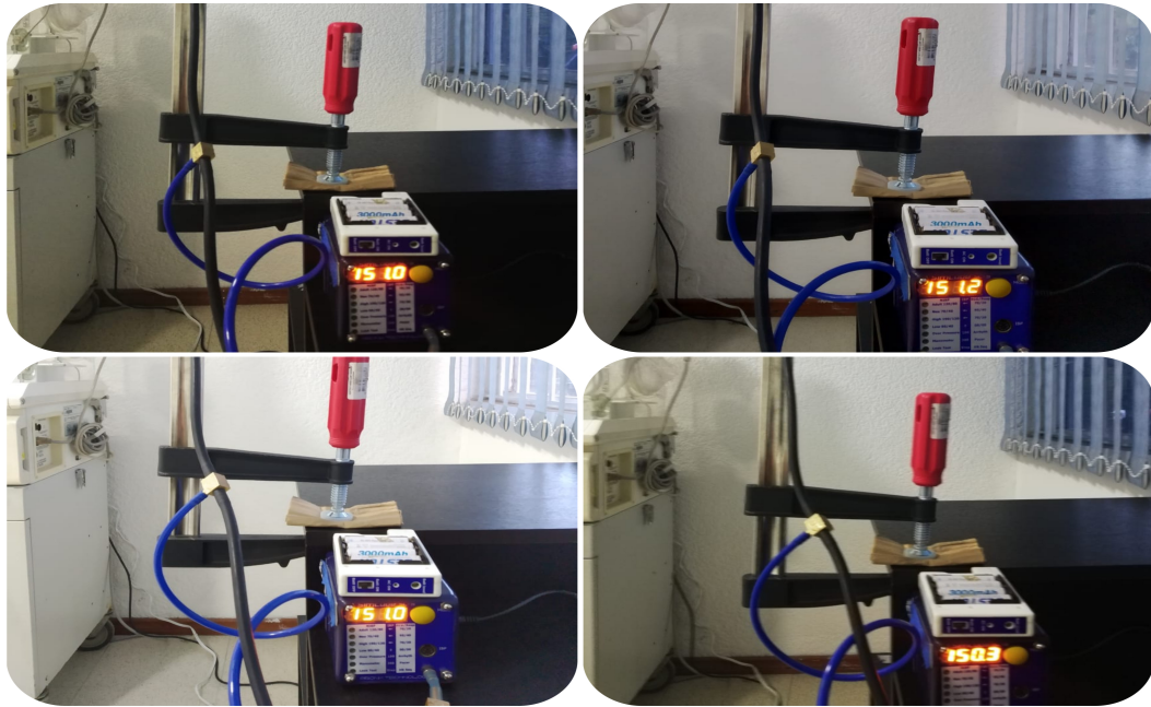
Figura A.15: Indicaciones para 150 mmHg a una altura de 43,5 cm.(Fuente: Esta investigación.)
