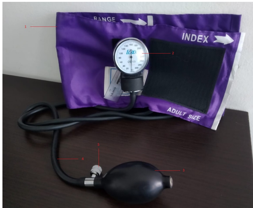
Figura 3.10: Partes de un tensiómetro mecánico: 1.Brazalete, 2. Manómetro, 3. Pera, 4. Tubos, 5. Perilla. (Fuente: Esta investigación.)
