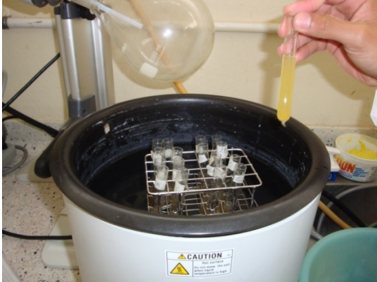
Imagen 3.25 Proceso térmico de los zumos de fruta
