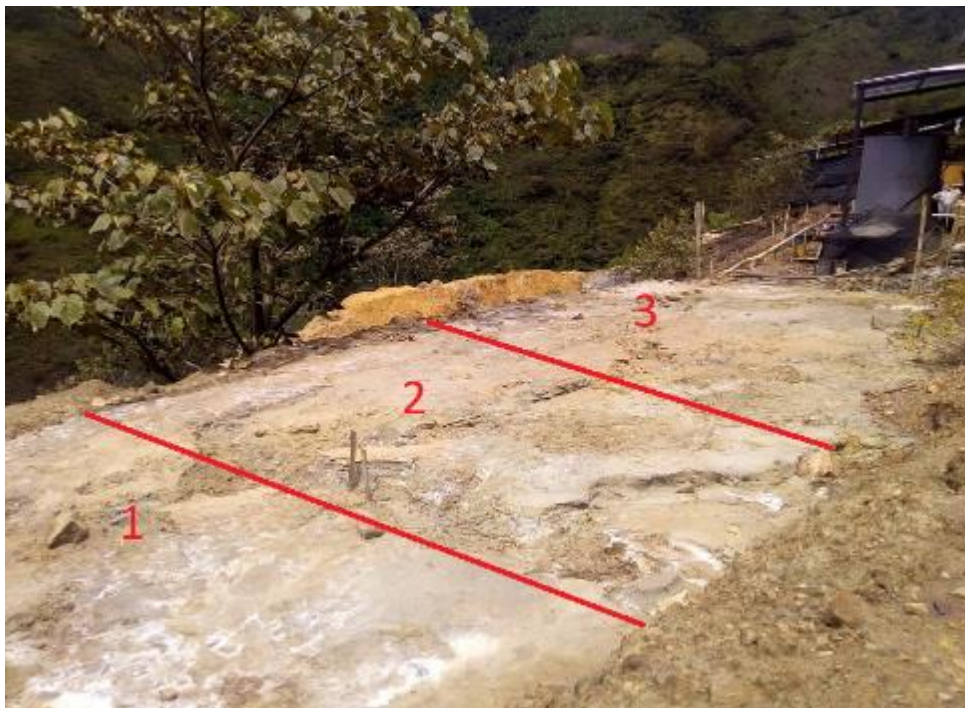
Figura 4. Depósito de arena uno ubicada en la mina Ecominer SAS, en Sotomayor, Nariño. La piscina fue dividida en tres parcelas para la toma de muestras. Fuente: Este estudio.
