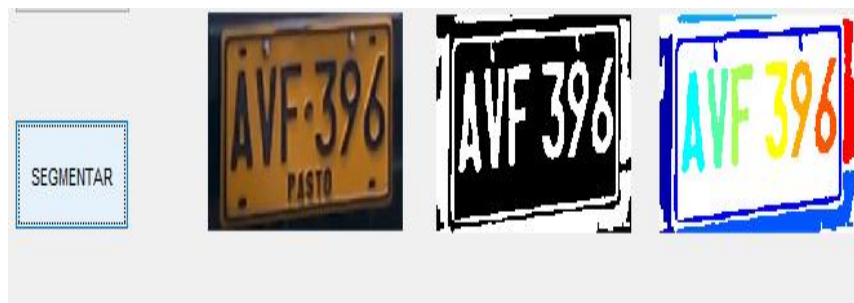
Figura 26. Botón segmentar en funcionamiento. Separación de caracteres de la placa.
