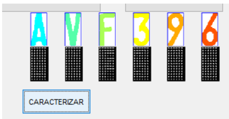
Figura 27. Extracción de características HOG de los caracteres
