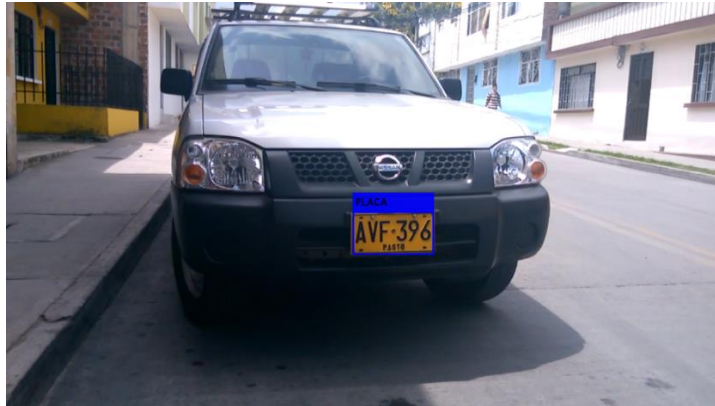
Figura 5. Detección de una placa vehicular sobre una imagen, la placa localiza y se marca con un recuadro azul.
