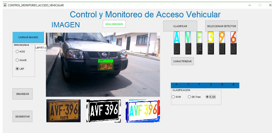
Figura 22. Interfaz de usuario. La figura muestra la interfaz de usuario para el reconocimiento de matrículas.
