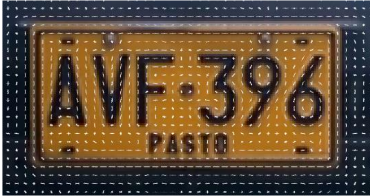
Figura 4. Descriptores HOG sobrepuestos sobre una imagen.
