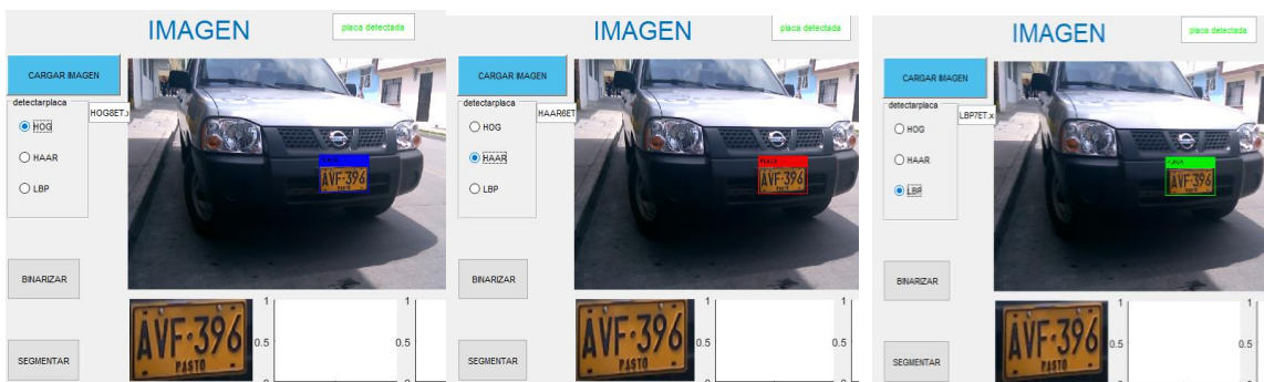
Figura 24. Detectores de placa en funcionamiento. Cada detector se diferencia por el color del recuadro de detección, azul para HOG, rojo para HAAR y verde para LBP
