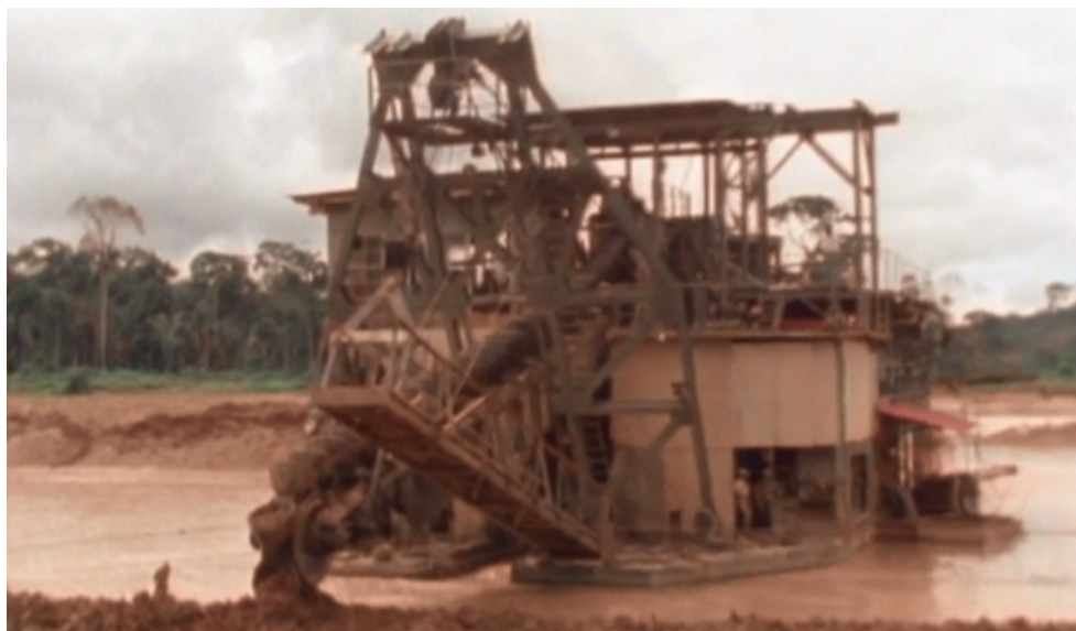
Figura 31. Dragado extrayendo casiterita en el territorio Uru Eu Wau Wau Fuente: Na Trilha dos Uru Eu Wau Wau; PUC Goiás.
