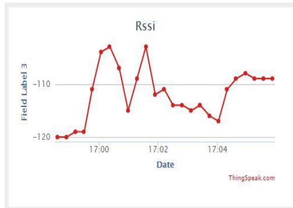
Figura 6. Indicador de fuerza de la señal recibida (RSSI) de Dragino.
