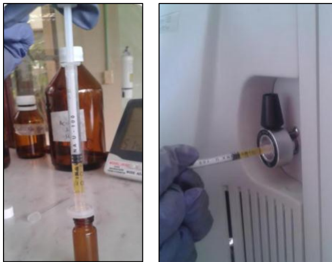
Figura 12. Inyección de las muestras el equipo HPLC para identificación y cuantificación de carotenoides.
