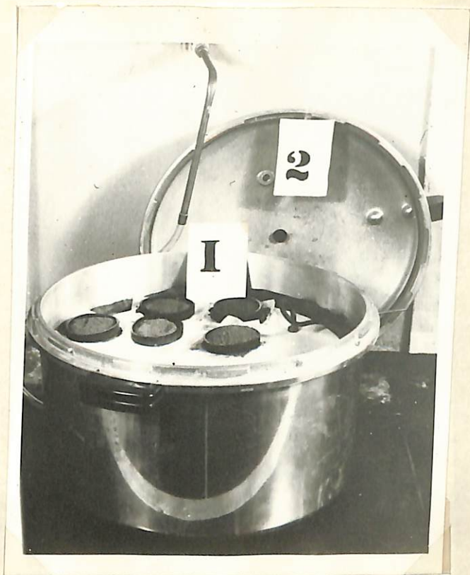
Figura 3. Aparato empleado en la determinación de la capacidad de campo
