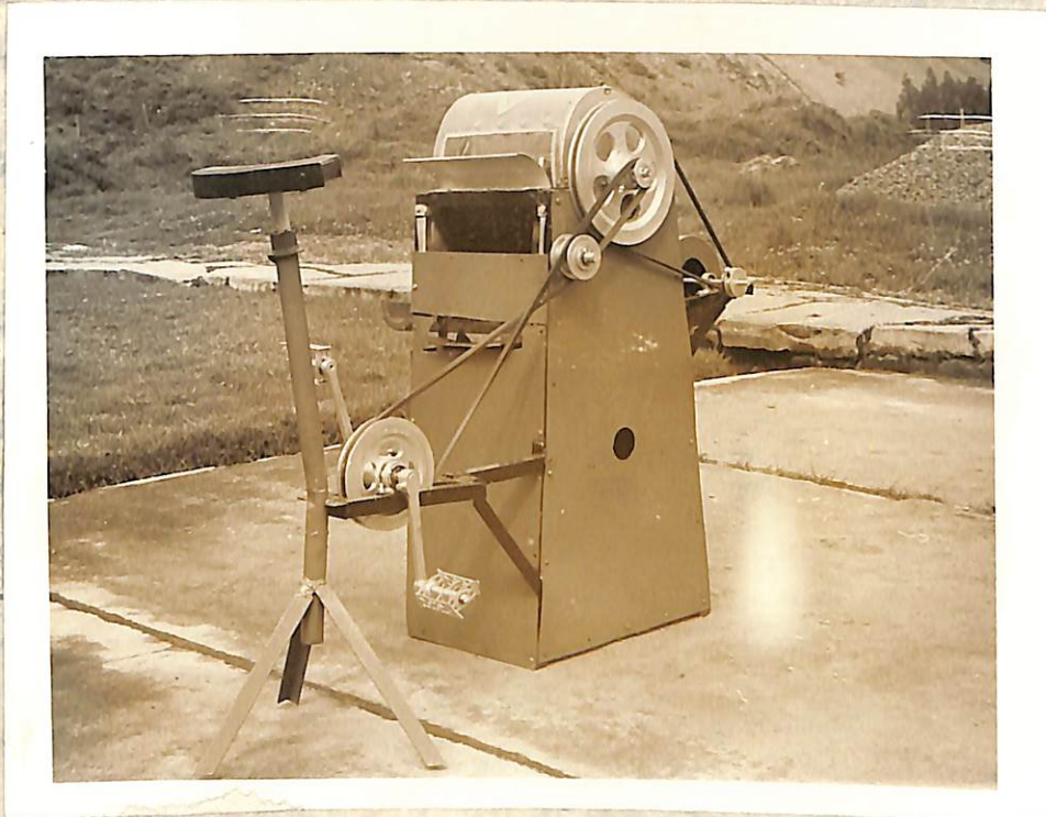
Figura 2. Vista frontal lateral derecha. Se observa en orden descendente: el elemento de trilla y tolva de alimentación, inmediatamente después la abertura - que permite la calibración de separación del cóncavo con el cilindro; seguidamente está el canal rectangular de salida de la cáscara del grano.
