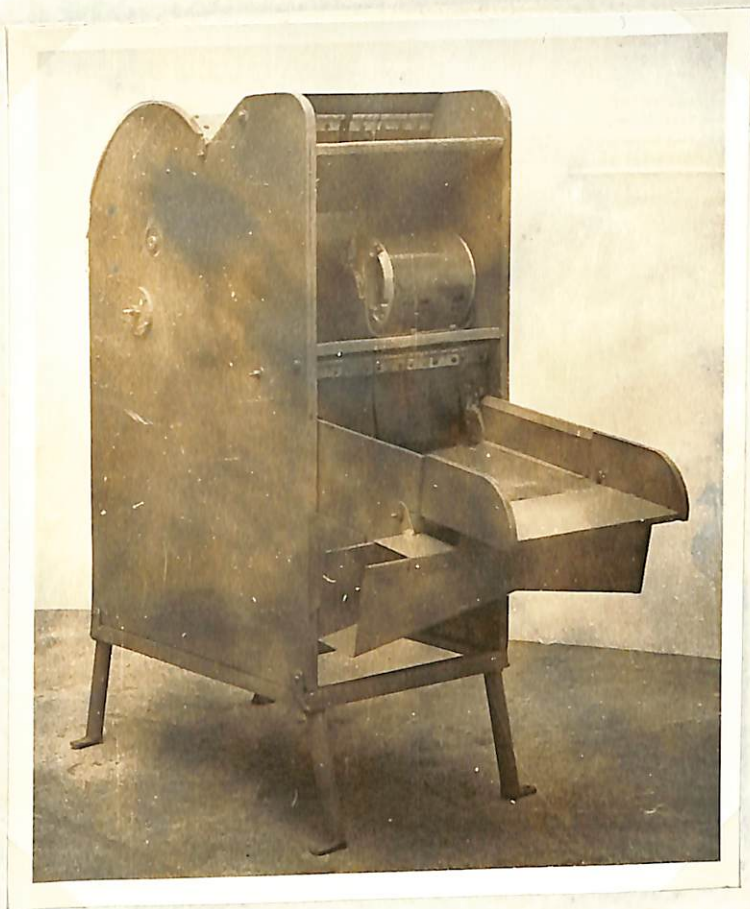
Figura 8.- Angulo izquierdo extremo anterior. Obsérvese la unidad para establecer el movimiento, el canal de colección del "granzón" y la tolva de salida de la "paja".
