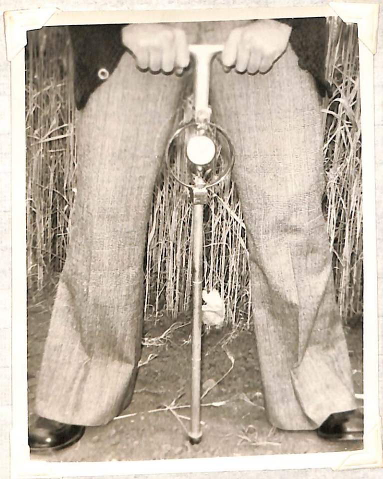
Figura 5. Modo de empleo del penetrómetro de cono modelo 1K-2B.
