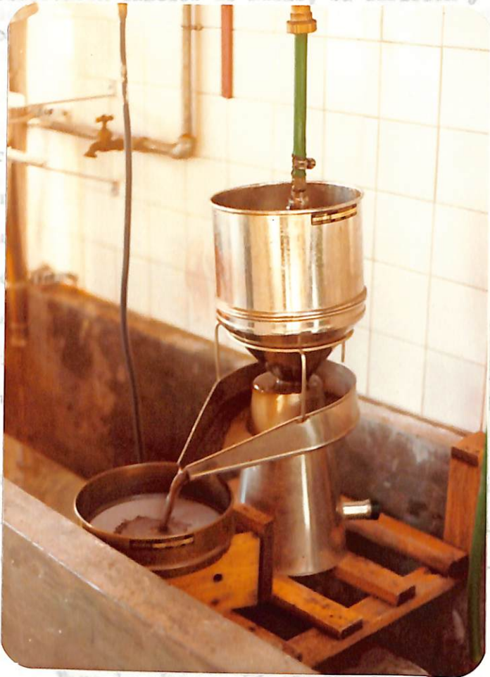
Figura 2: Elutriador de Fenwick para se- paración de quistes del nemáto do quiste de la papa Globodera pallida .
