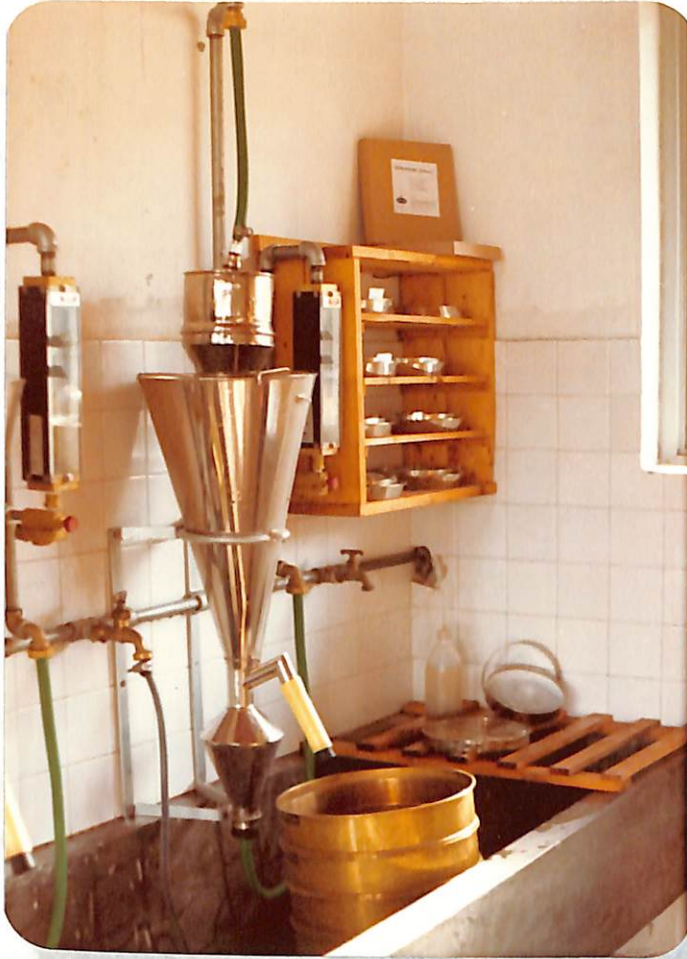
Figura. 1: Elutriador Oostenbrink para separación de larvas de Globodera pallida y nemátodos filiformes.
