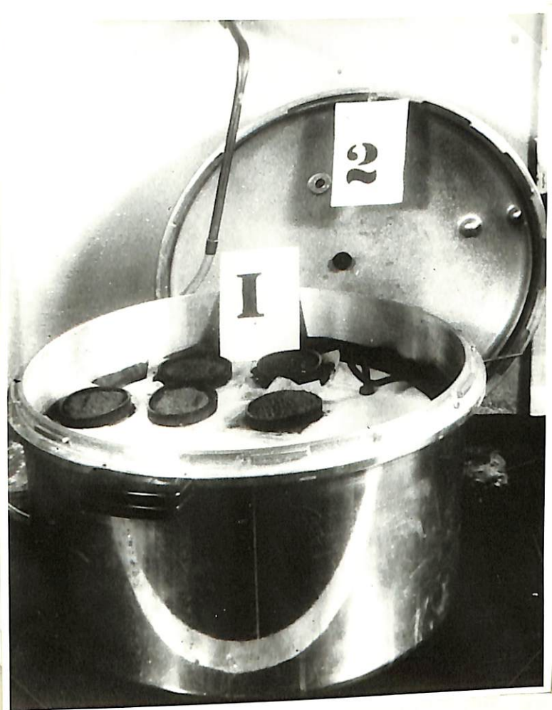
Figura No. 7 Aparato empleado para determinar la capacidad de campo.
