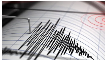
Figura 2. Sismógrafo registrando ondas sísmicas terrestres. Imagen obtenida de: [2]
