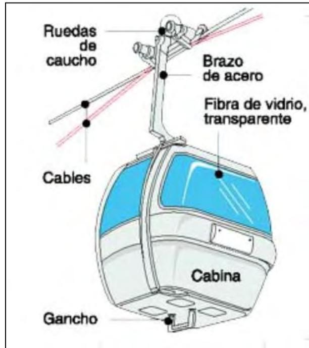
Figura 115 – Cabina teleférico
