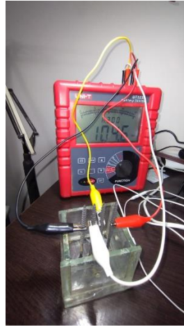
Medición en laboratorio de física de suelos de resistividad eléctrica en función de concentración de NaCl diluido en agua ultra pura.
