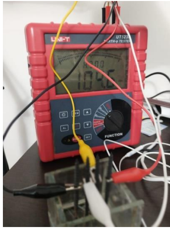
Medición en laboratorio de física de suelos de resistividad eléctrica en función de concentración de NaCl diluido en agua ultra pura.
