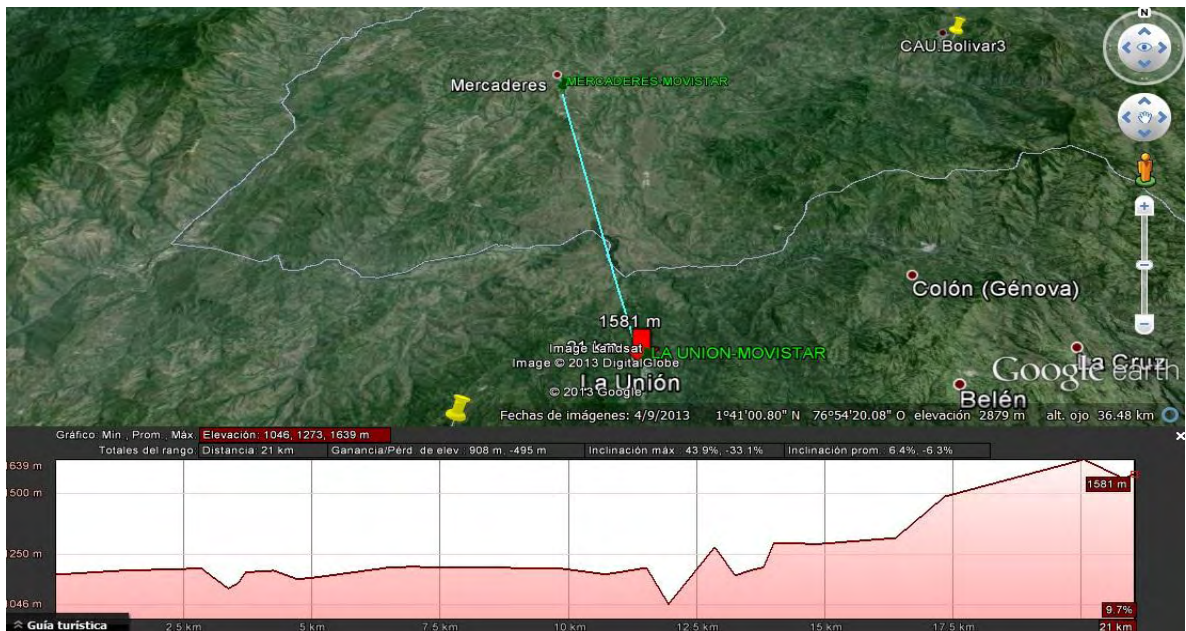
Figura 23. Mapa transmisión y perfil de elevación radioenlace Mercaderes-La Unión diseñado en Google Earth.
