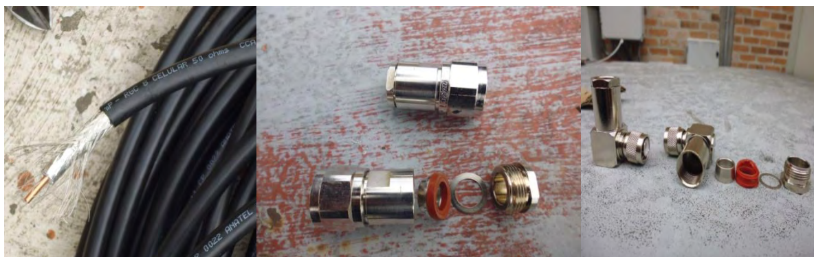
figura21. De izquierda a derecha: cable RG8 y sus capas, conector tipo N hembra recto, conector TNC hembra en L y sus partes. Fuente: propia de este trabajo
