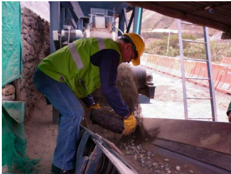
Figura N° 25 – Recolección de muestras – Recolección de agregados pétreos y material llenante desde la banda transportadora en planta de producción de asfalto.
