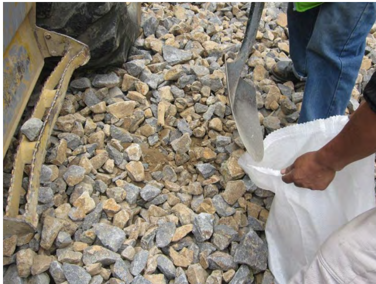
Figura N° 4 – Recolección de muestras – Agregado grueso para ensayos de laboratorio
