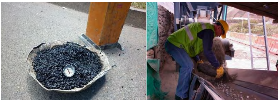
Figura N° 5 – Recolección de muestras – Mezcla asfáltica y material llenante para mezcla asfáltica
