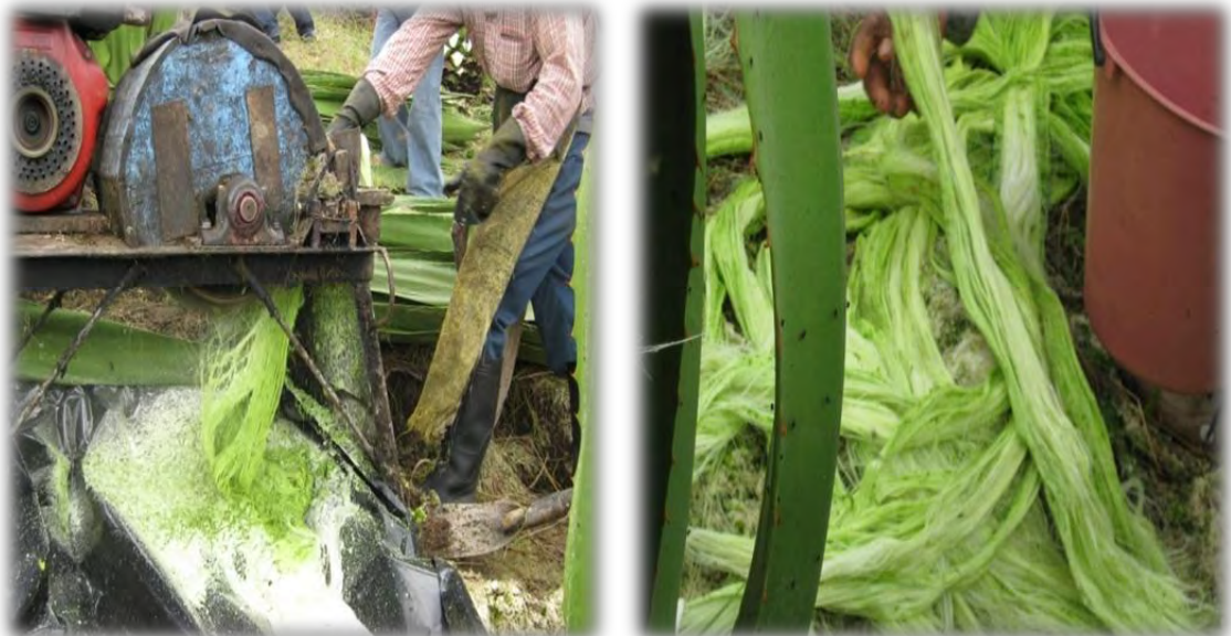
Figura 2. Proceso de desfibrado del fique y generación de biosólidos (izquierda) y Obtención de la fibra (derecha).
