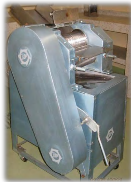
Figura 20. Molino para la extracción del jugo de la Universidad de Nariño, Planta Piloto de la Facultad de Ingeniería Agroindustrial.
