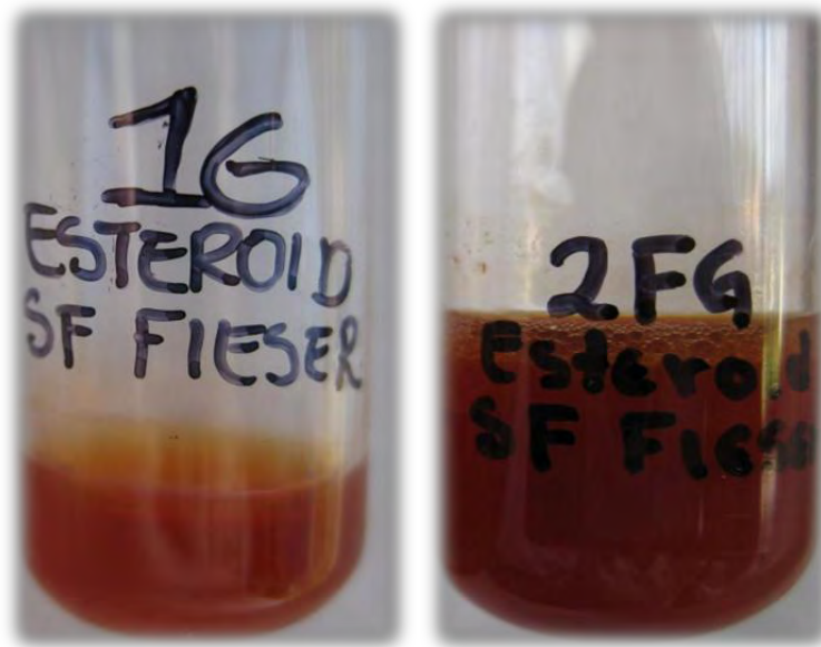
Figura 47. Prueba de Fieser positiva para esteroides con SF de 1G y 2FG.
