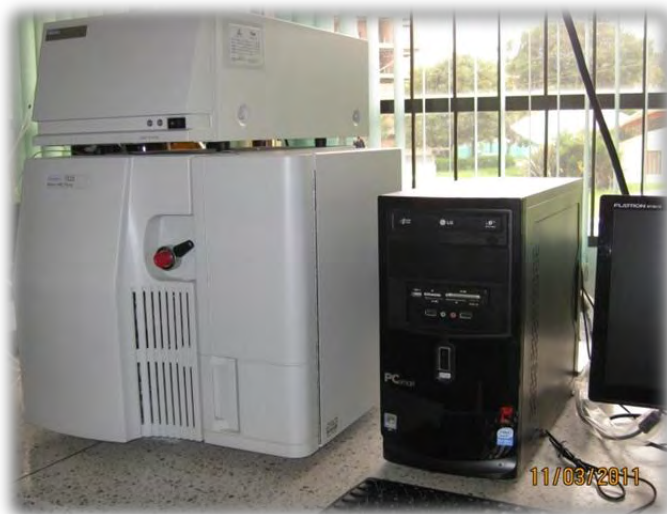
Figura 31. Equipo de cromatografía líquida de alta eficiencia (CLAE) con bomba binaria 1525 y detector DAD WATERS 2998.
