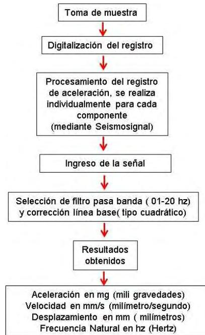
Figura 4.1. Esquema para estimar la frecuencia natural en edificaciones
