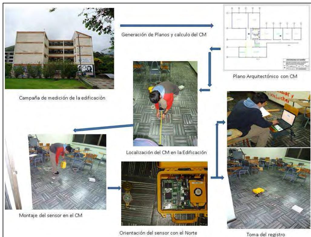
**Figura 5.1.** Esquema ilustrativo de la recopilación de la información y medida de las microtrepidaciones en el sitio - ejemplo Bloque 3
