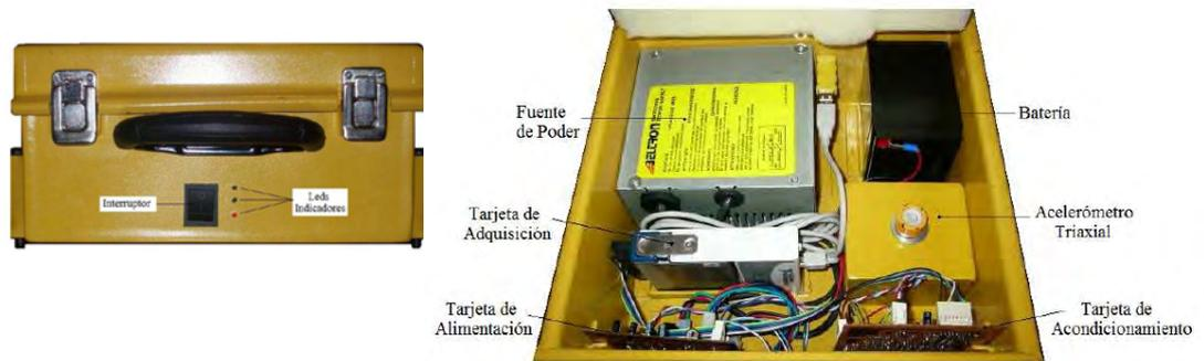
**Figura A.2** Acelerógrafo EAR\_1 (Rosero y Cadena, 2009)
