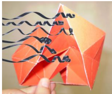
Figura 10. SIMULACIÓN CON CINTAS Y VENTILADOR - MODELO EXPERIMENTAL
