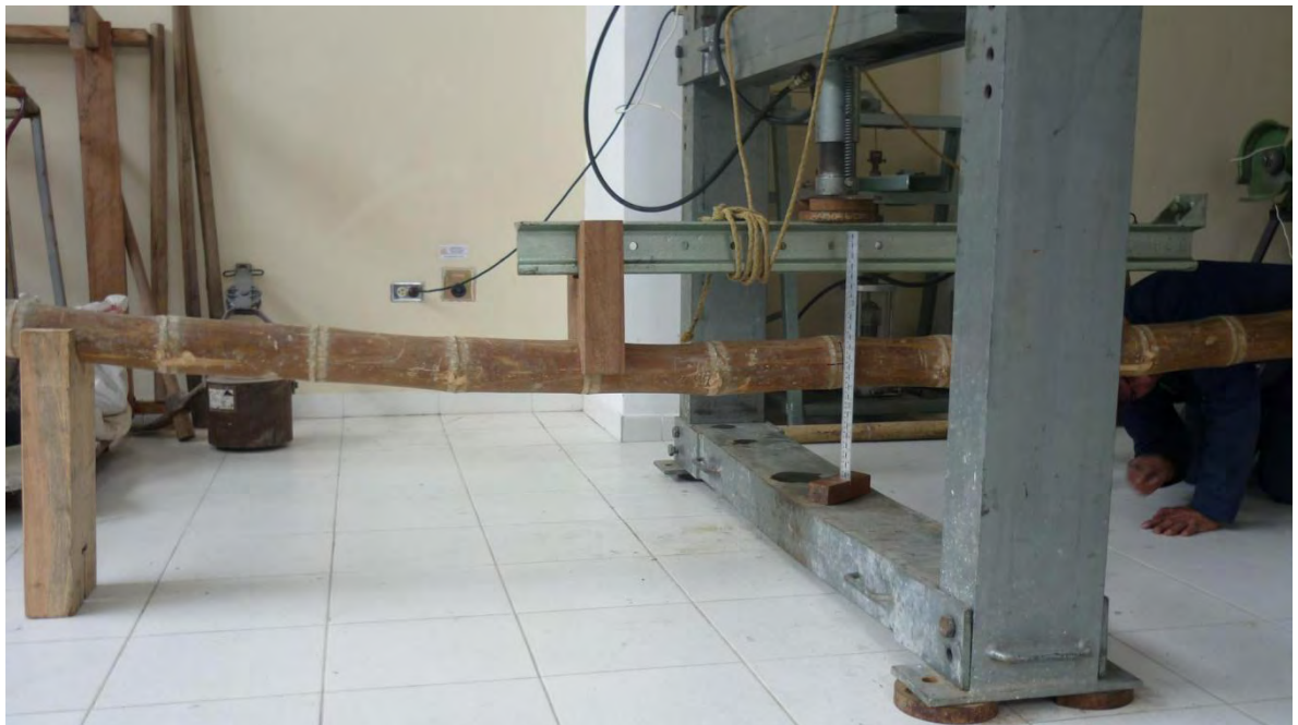
Foto 14. Montaje del ensayo de flexión
