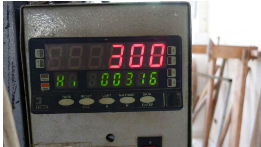
Foto 12. Medidor de carga en el ensayo de flexión
