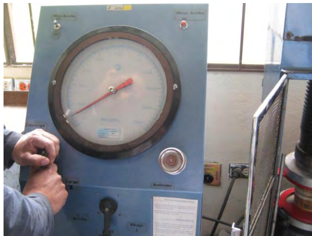
Foto 9. Equipo para medir la carga en el ensayo de compresión y corte
