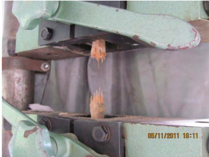
Foto 18. Falla de una probeta de ensayo a tensión.
