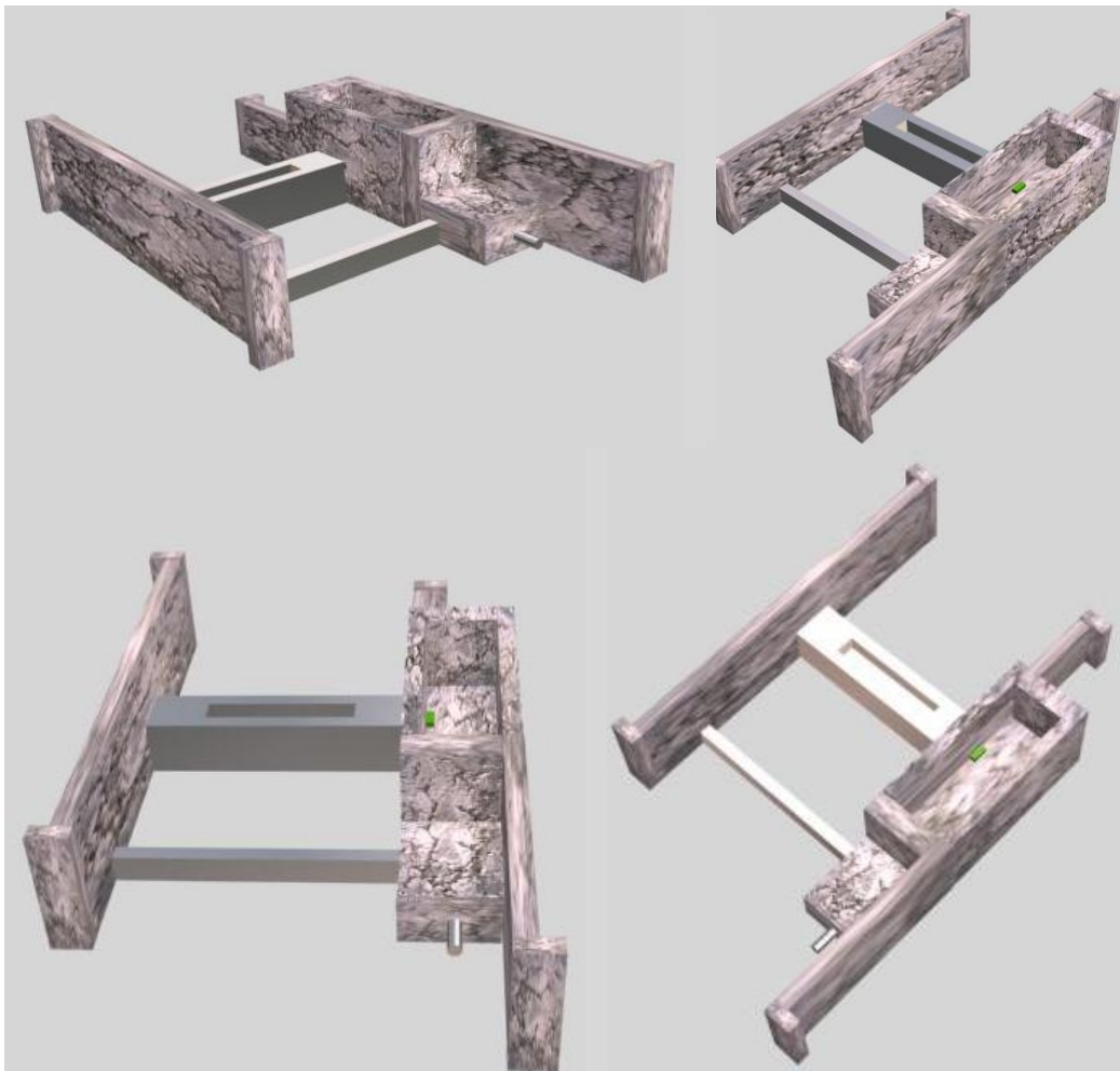
Figura 110. Bocatoma de fondo
