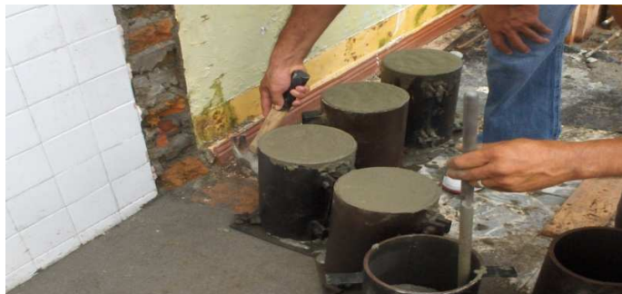
Fotografía 143: Toma de muestra de concreto.
