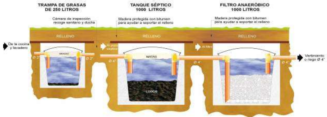
GRAFICO 5 Esquema de utilización de pozo séptico
