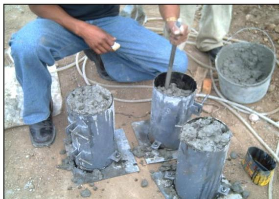
**7.2.3. Análisis de resultados.** Según los resultados arrojados por el ensayo de resistencia a la compresión del concreto, éste alcanza su resistencia máxima (3000psi) a los 28 días; esto quiere decir que el concreto empleado en obra cumple con las especificaciones de diseño y por lo tanto se garantiza la calidad y durabilidad de la obra.
