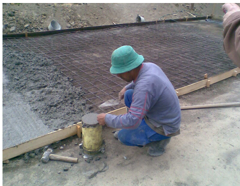
Imagen 61. Toma de cilindros para ensayos a compresión.
