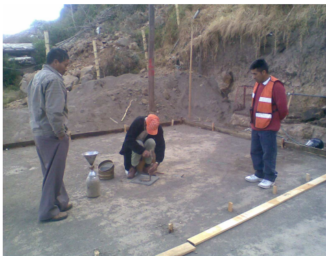
Imagen 58. Ensayo del cono y la Arena en la obra.
