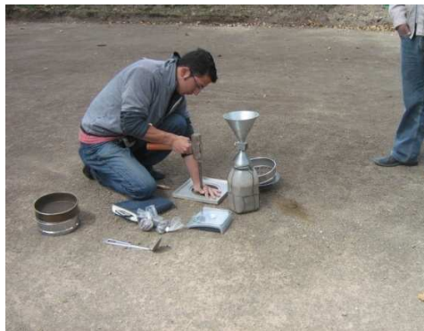
Imagen 105. Ensayo cono y arena en obra
