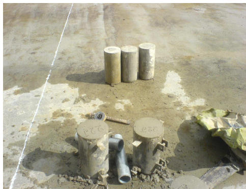
Imagen 78. Toma de cilindros para ensayos a compresión
