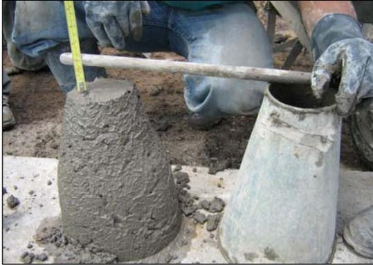
FIGURA 60.- ENSAYO DE SLUMP
