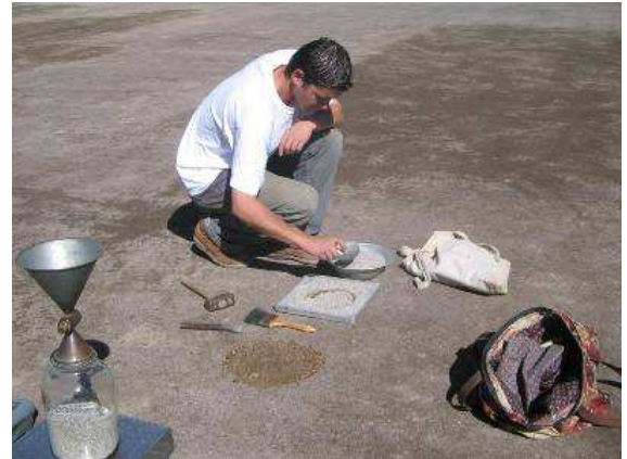
Fig. No 51 Ensayo del cono y la arena.
