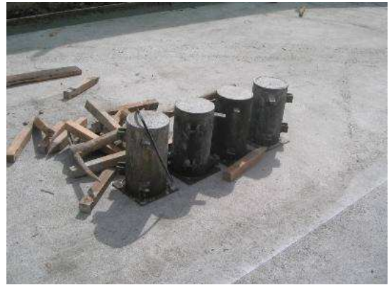
Fig. No53 Toma de cilindros
