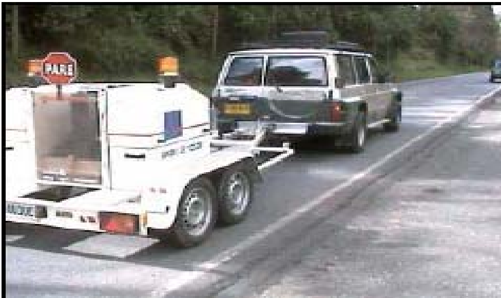
Figura 6. Equipo utilizado FWD Modelo PRI2100 Carl Bro.
