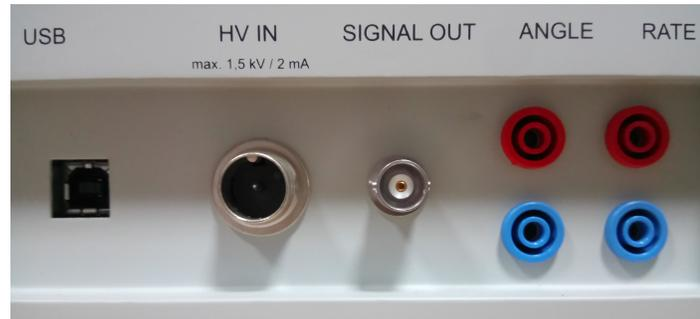
Figura 2.14: Fotografía del panel de conexiones del equipo de rayos X 554 801 [9].
