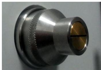
Figura 2.11: Fotografía del colimador del equipo de rayos X 554 801 [9].
