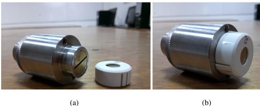
Figura 2.12: Fotografía del colimador y el filtro [9].
