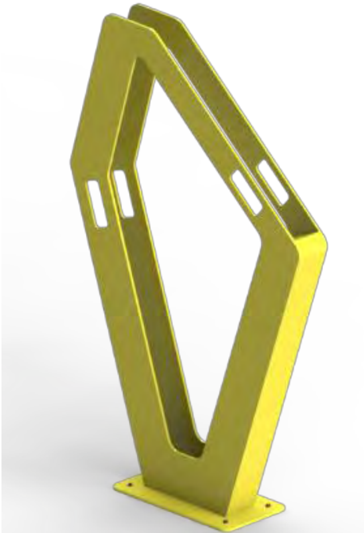
Figura 43 Modelo 3D - Parqueadero de piso doble Fuente. Diseño propio.
