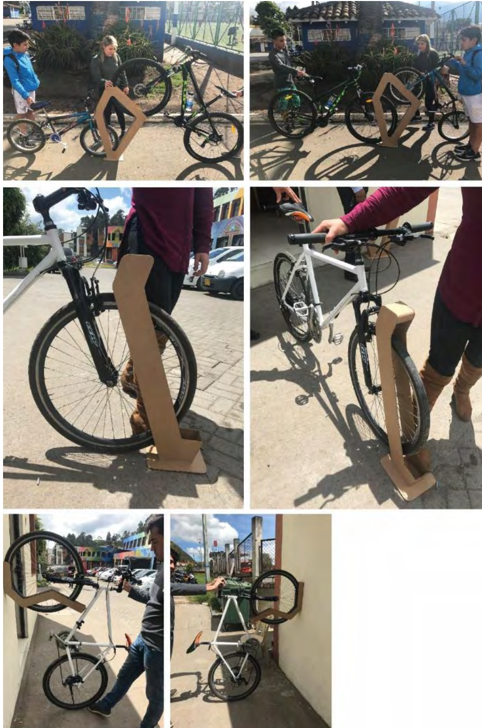
Figura 36 Testeo prototipos - Cartón corrugado
