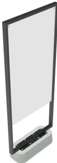
*Nota.* Detalles de construcción: Platina 2" x 1/8 Pulgadas soldadas en T. Anclaje a la base con platinas expuestas. Los tornillos de expansión están a mínimo 6 Cm de distancia del borde y a 10 Cm mínimo de distancia entre ellos. Se perforan alrededor de 1 cm de profundidad adicional al largo del tornillo
