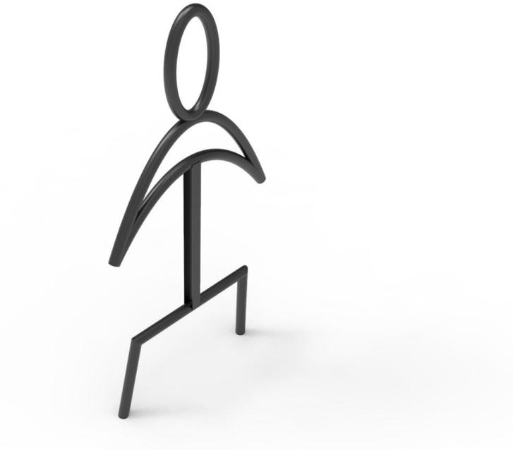
*Nota.* Detalles de construcción: Pieza fabricada en acero inoxidable, tubular de agua negra pintado o acero galvanizado. Embestido en cimentación de concreto. Pintura en Poliester / Pintura Electrostática. Platina 2 x 1/8 Pulg soldadas en H soldadas a la tubería
