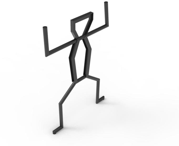
*Nota.* Detalles de construcción: Pieza fabricada en acero inoxidable, tubular de agua negra pintado o acero galvanizado. Embestido en cimentación de concreto. Pintura en Poliester / Pintura Electrostática. Platina 2 x 1/8 Pulg soldadas en H soldadas a la tubería
