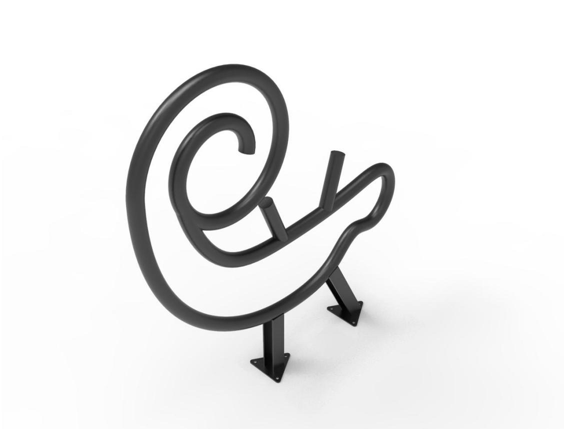
*Nota.* Detalles de construcción: Pieza fabricada en acero inoxidable, tubular de agua negra pintado o acero galvanizado. Anclaje al pavimento existente. Pintura en Poliester / Pintura Electrostática. Platina 2 x 1/8 Pulg soldadas en H soldadas a la tubería
