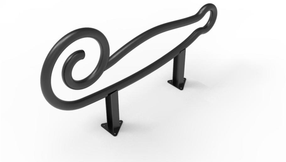
*Nota.* Detalles de construcción: Pieza fabricada en acero inoxidable, tubular de agua negra pintado o acero galvanizado. Anclaje al pavimento existente. Pintura en Poliester / Pintura Electrostática. Platina 2 x 1/8 Pulg soldadas en H soldadas a la tubería
