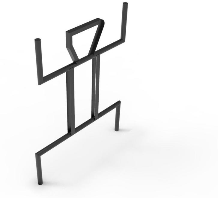
*Nota.* Detalles de construcción: Pieza fabricada en acero inoxidable, tubular de agua negra pintado o acero galvanizado. Embestido en cimentación de concreto. Pintura en Poliester / Pintura Electrostática. Platina 2 x 1/8 Pulg soldadas en H soldadas a la tubería
