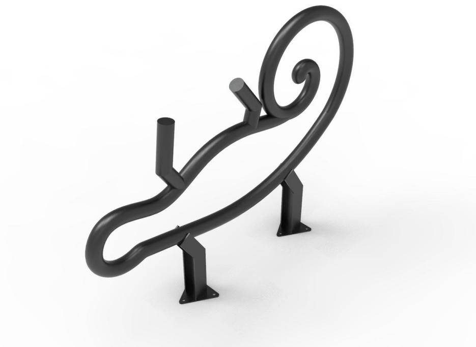
*Nota.* Detalles de construcción: Pieza fabricada en acero inoxidable, tubular de agua negra pintado o acero galvanizado. Anclaje al pavimento existente. Pintura en Poliester / Pintura Electrostática. Platina 2 x 1/8 Pulg soldadas en H soldadas a la tubería
