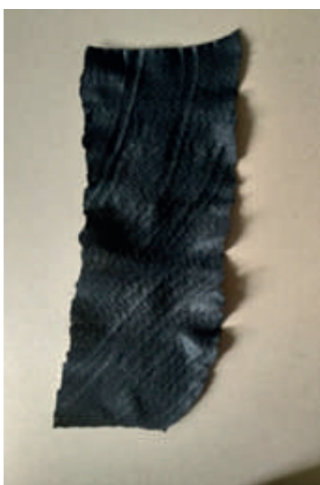
Geotextil de una capa
