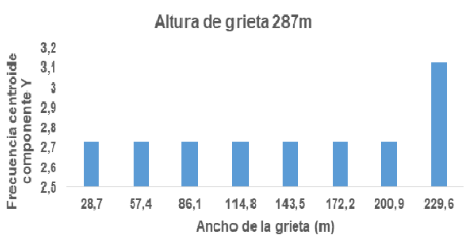
Figura 6.19: Gráfica de componente Y de frecuencia centroide vs ancho de grieta para una altura de 287m.
