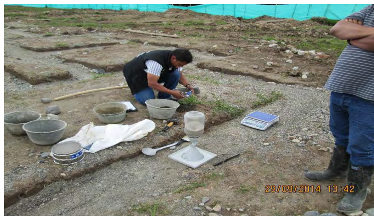
Figura 6. Prueba de densidades.
