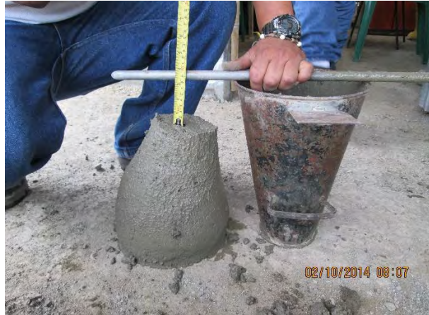
Figura 3. Realización del ensayo de asentamiento In situ.
