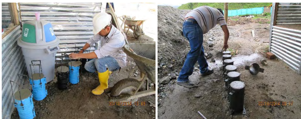
Figura 4. Cilindros para el ensayo de compresión.
