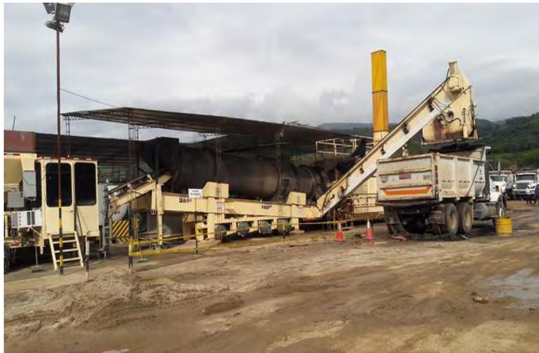
**Imagen 39. Cargue y transporte de la mezcla Asfáltica**
