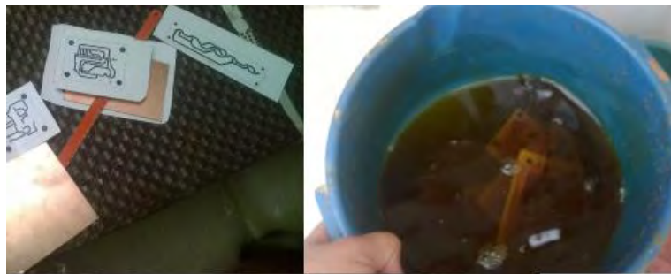
Figura 62. Proceso de elaboración de circuitos impresos con método de planchado.
