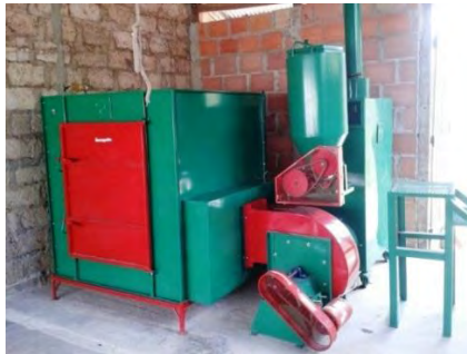
Figura 14. Secadora Mecánica Con estructura Fija.
