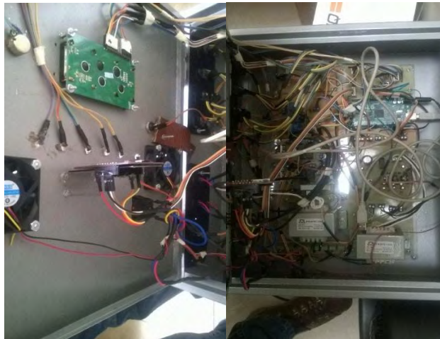
Figura 79. Montaje de las tarjetas electrónicas en la carcasa.
