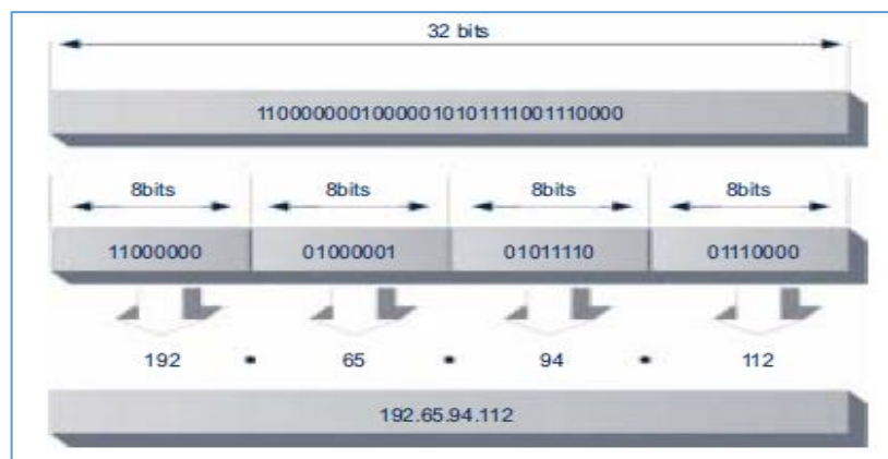
Figura 5. Representación de una dirección IP
