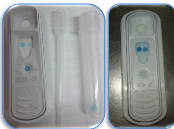
Figura 15. Kit de Snap Betalactámicos y resultado negativo para la prueba
