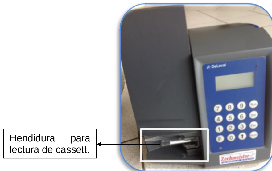
Figura 13. Contador de células somáticas DCC de DeLaval.
