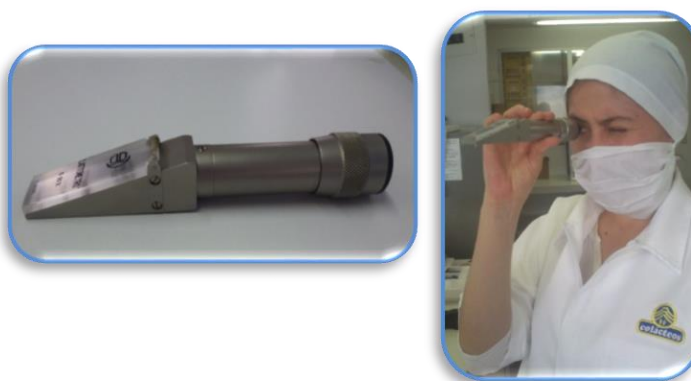
Figura 3. Lactómetro de Bertuzzi (0-20% L34657) - Determinación de sólidos no grasos.
