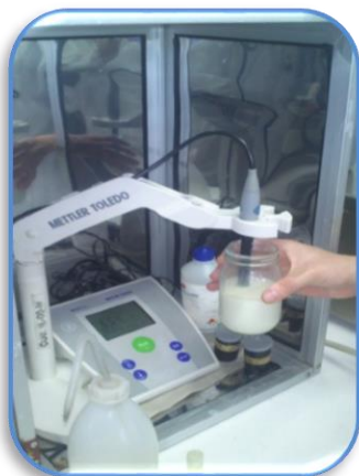
Figura 5. pH-metro (Mettler Toledo Seven Easy 8603) - Medición de pH.
