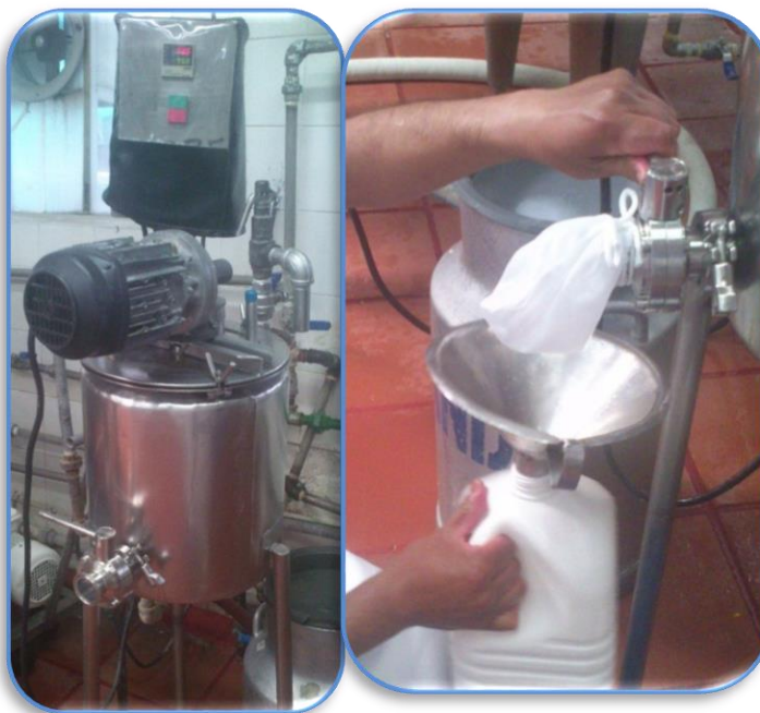
Figura 22. Marmita utilizada y toma de muestra en los ensayos de pasteurización de leche de cabra.
