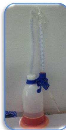
Figura 6. Acidímetro 0-100°D Medición de acidez titulable.
