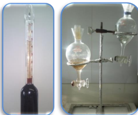
Figura 4. Butirómetro y dosificador Gerber- Determinación de Materia grasa.
